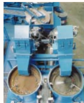
Sortierung von Altbatterien durch Sensoren.
